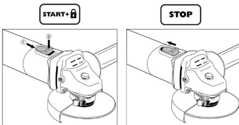
**Включение/выключение.** Для **включения** прибора сдвиньте выключатель по направлению к редуктору.
