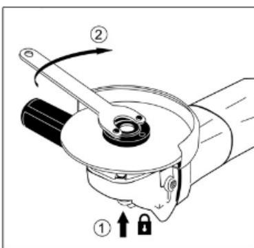
**Внимание!** Запрещается пользоваться кнопкой-фиксатором для остановки вращающегося шпинделя. Это может привести к повреждению устройства! После установки рабочей оснастки убедитесь, что оснастка вращается легко и ничего не задевает. Проверить это можно путем вращения вручную оснастки. Всегда при замене/установке дисков очищайте от грязи шпиндель, посадочную шайбу, прижимную шайбу, кожух, диск.
