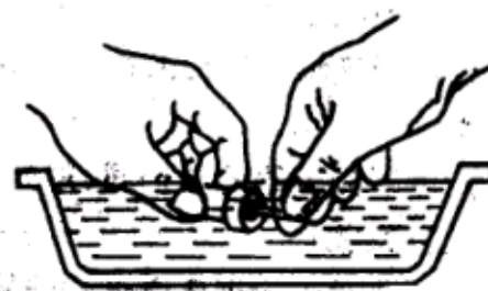
Рис. 21 Промойте корпус форсунки и игольчатый клапан
