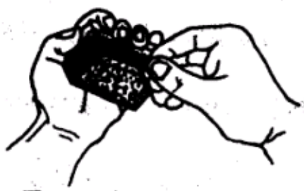
Рис. 20 Удалите нагар с игольчатого клапана
