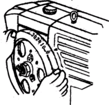
Рис. 18 Отметка ВМТ на маховике
