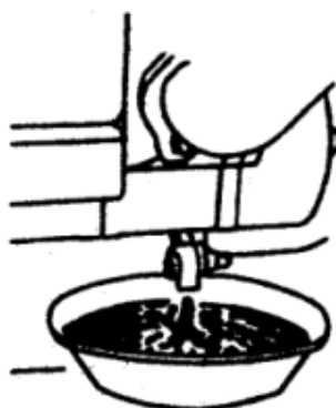
Рис. 16 Слейте охлаждающую воду
