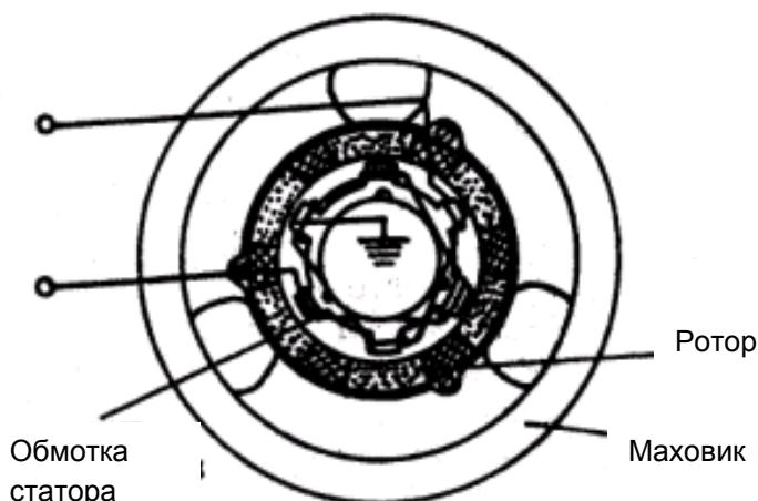
Рис. 28 Динамо-машина с маховиком 90 Ватт
