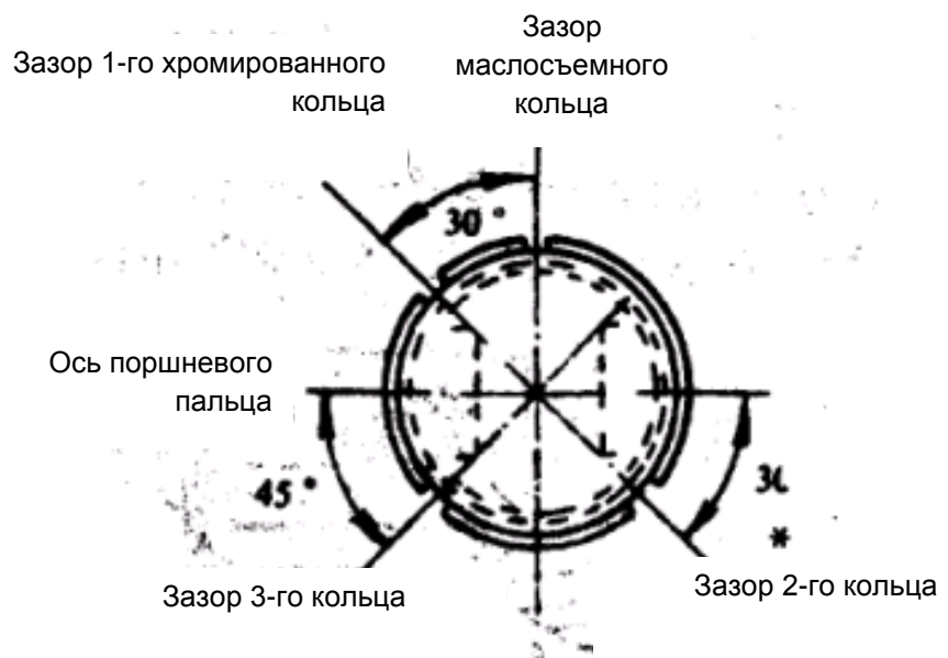
Рис. 24 Кольца со ступенчатым расположением зазоров
