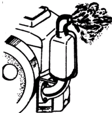
Рис. 13 Выхлопной газ черного цвета
