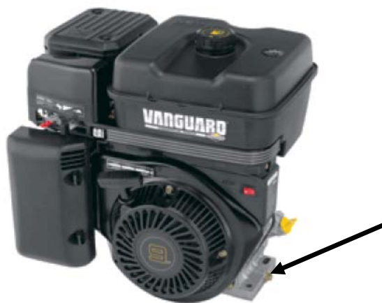
Рис. 4.5: Удаление винта для слива масла
