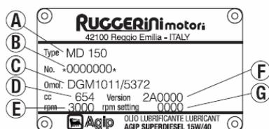
Заводская табличка двигателя установлена на air conveyor (1, Рисунок 1)
