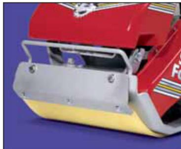
К машинам моделей Silver Fox можно присоединять прикрепляемые болтами полиуретановые маты, которые обеспечивают плавное скольжение виброплиты по камням при работах по укладке и уплотнению ландшафтных брусков, тротуарного камня, булыжника, и брусчатки без опасности поцарапать или повредить поверхность покрытия.
