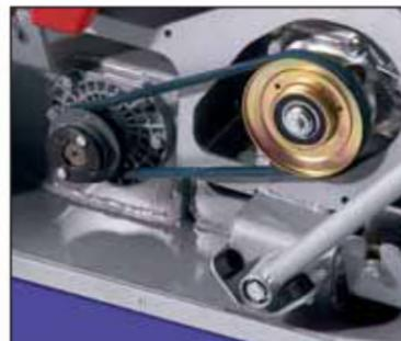
Сверхпрочный ремень из кевлара, изготовленный из волокна, который применяется в космической технике, служит так же долго, как и обыкновенные ремни, но приводит синхронизированную эксцентриковую систему с более высоким КПД передачи мощности.
