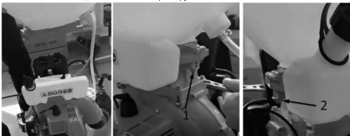
Рисунок 19 – Установка бака для химикатов
