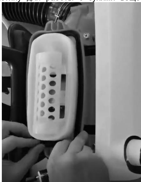
Рисунок 18 – Установка пластины для работы с сухими веществами
