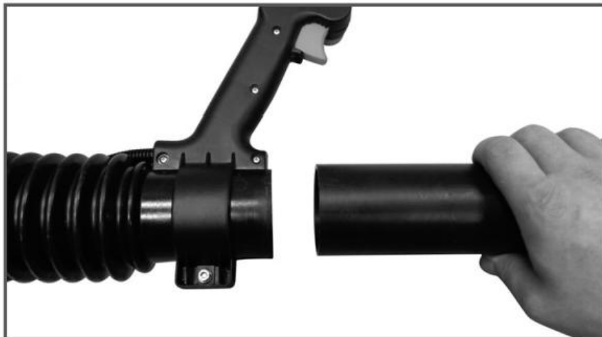
Рисунок 5 - Установка трубы напорной
