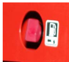
Рис. 4.8: Закрывать топливный кран
