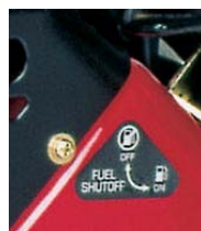
Рис 4.6: Выключение топливного крана
