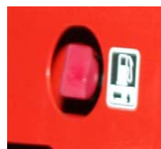
Рис 4.6: Выключение топливного крана
