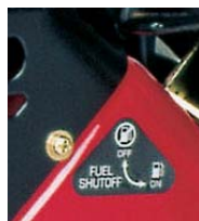
Рис. 4.8: Закрывать топливный кран
