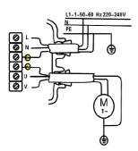
Схема подключения насосов с однофазным сечением жил, напряжением 230 В и мощностью до 1,1 кВт.
