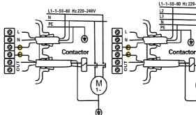
Схема подключения насосов с однофазным сечением жил, напряжением 230 В и мощностью более 1,1 кВт., через пульт дистанционного управления.
