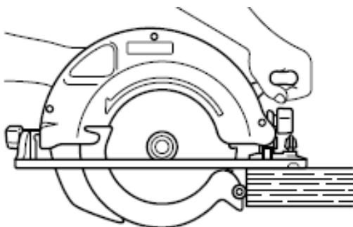
Е) Установите основание (1) на заготовку таким образом, чтобы упор кожуха подвижного касался заготовки. Не позволяйте пильному диску пилы касаться заготовки. При начале резки подвижный защитный кожух уйдет в сторону при перемещении пилы вдоль рены реза.
