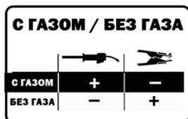
При необходимости сварки самозащитной порошковой проволокой (FLUX) без применения защитных газов подключите кабель выбора полярности (1а) к «-» (отрицательному) сварочному терминалу (5а).
