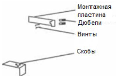
Требования по креплению обогревателя на стену: прибор должен быть прикреплен не менее чем в 100 мм от пола, также должно быть свободное пространство не менее 100 мм с боковых сторон, спереди и сверху от него. При установке обогревателя на стену необходимо демонтировать колеса с опорами, если они уже установлены.
