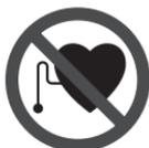
**Не располагайте измерительный инструмент вблизи электростимулятора сердца.** Магниты **14** создают поле, которое может отрицательно повлиять на функцию электростимулятора сердца.
