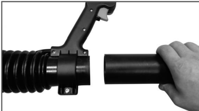
Рисунок 5 - Установка трубы напорной
