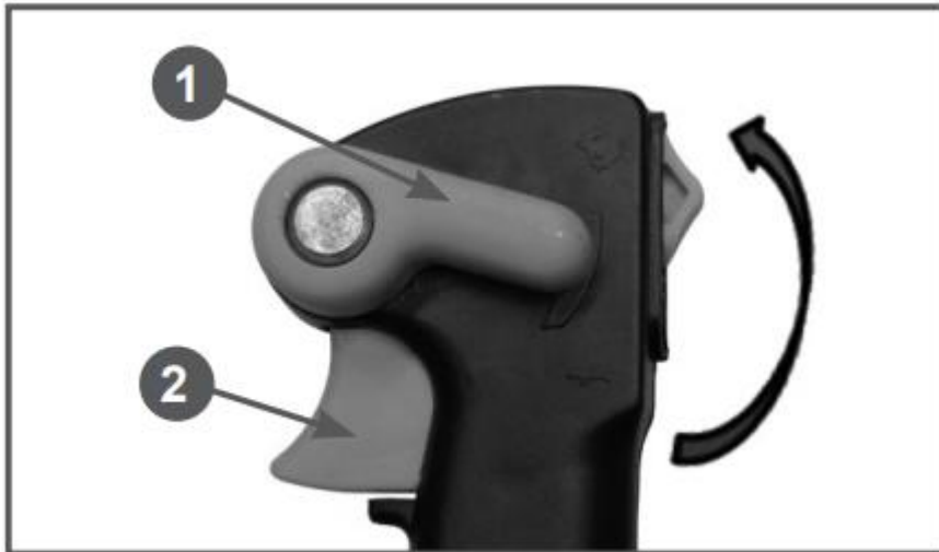
Рис. 25 Фиксатор курка газа (1 - Фиксатор курка газа; 2 - Курок газа)
