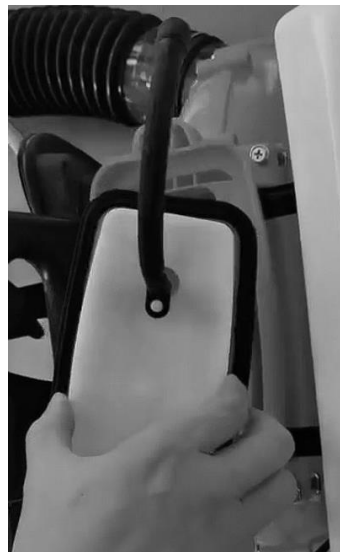
Рисунок 16 – Демонтаж пластины для работы с жидкостью
