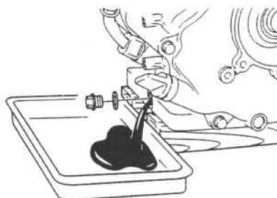
3. После установки сливной пробки на место залейте в картер высококачественное моторное масло через маслосливное отверстие.
