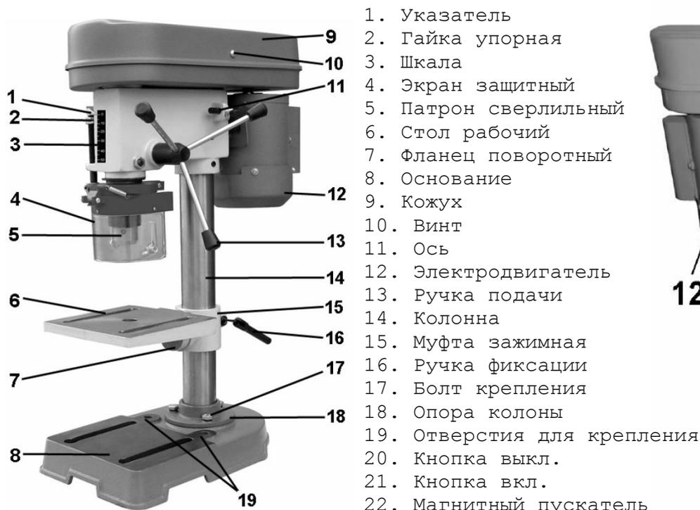
(Рис. 2) Устройство станка
