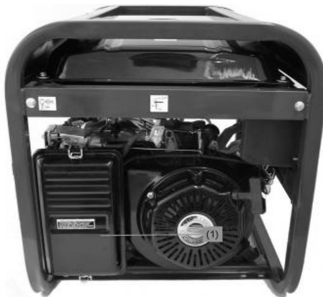
Рис. 4.10: Снятие воздушного фильтра
