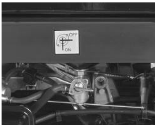
Рис. 4.2: Открыть/закрыть топливный кран
