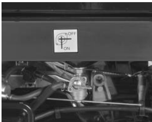
Рис. 4.8: Закрыть топливный кран
