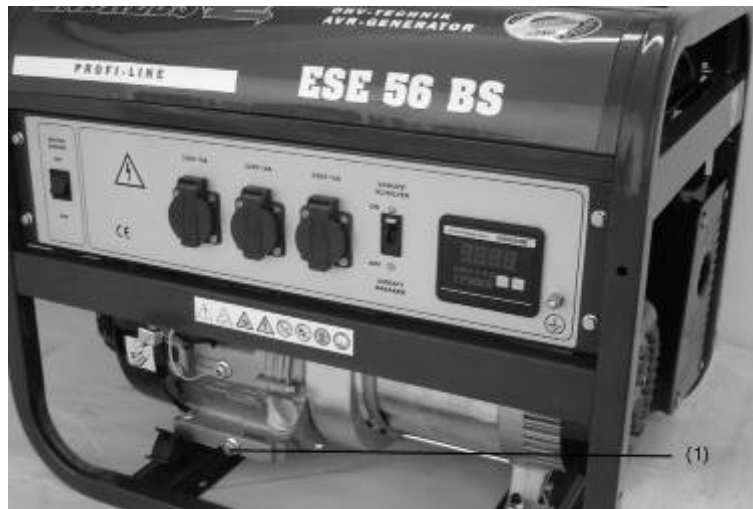
Рис. 4.7: Удаление винта для слива масла
