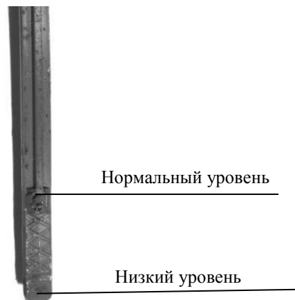
Рисунок 6 – Проверка уровня масла в корпусе редуктора
