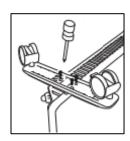
Установите колесики как показано на рисунке, и зафиксируйте шурупами. При установке кронштейна колесиков следите за тем, чтобы выступ опор колесиков попал в специальный паз на корпусе устройства.
