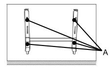
Требования по креплению обогревателя на стену: прибор должен быть прикреплен не менее чем в 200 мм от пола, также должно быть свободное пространство не менее 200 мм с боковых сторон и не менее 500 мм спереди от обогревателя и сверху от него. При установке обогревателя на стену необходимо демонтировать колеса с опорами, если они уже установлены.
