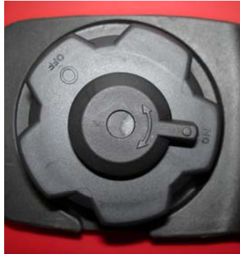
Рис. 4.1: Воздушный вентиль топливного бака (открыт)
