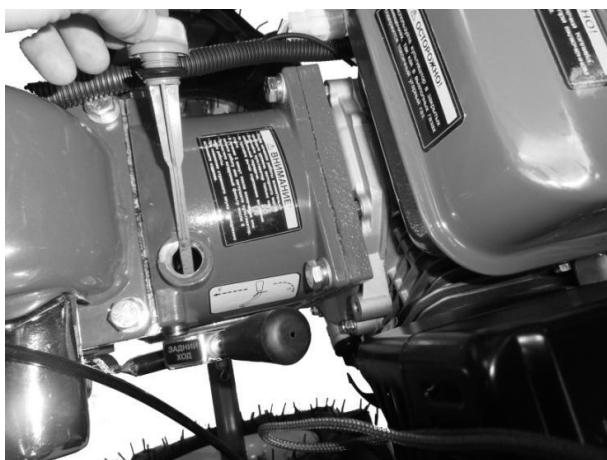
Рисунок 6 – Проверка уровня масла в корпусе редуктора
