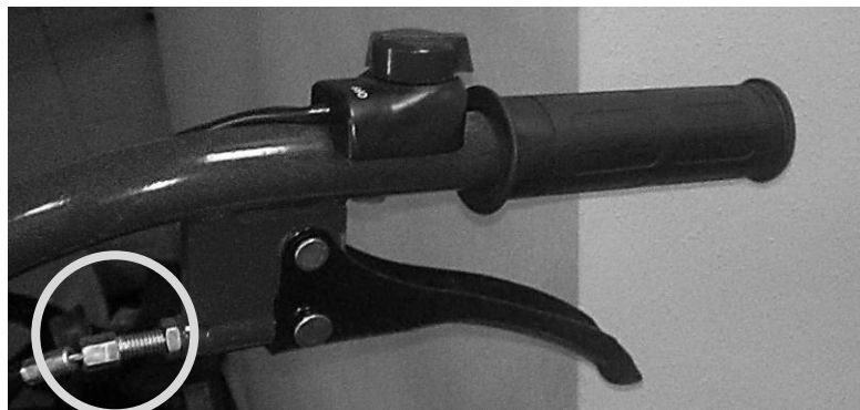
Рисунок 14 – Регулировка троса сцепления
