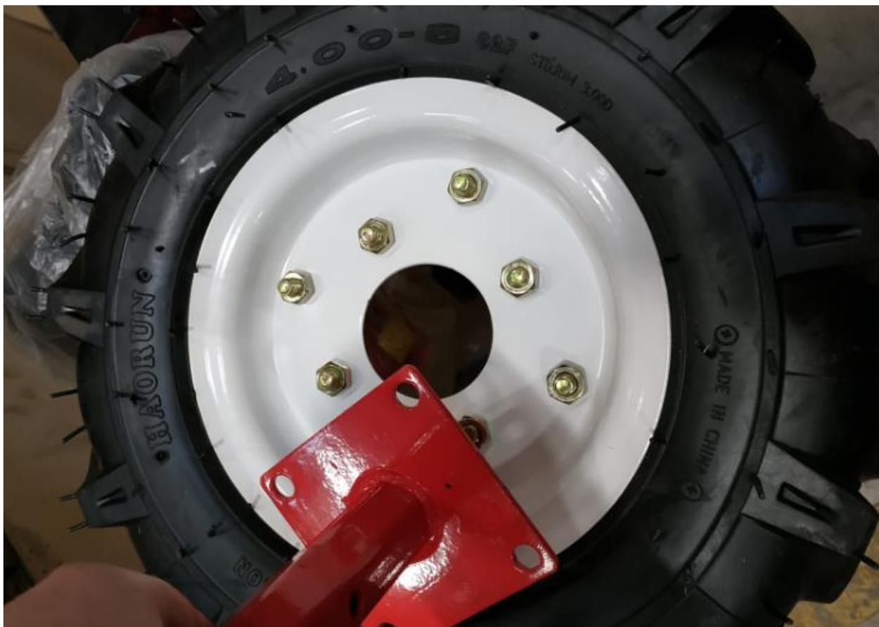
4. Установите культиватор на колёса и переднюю подставку. Зафиксируйте колёса пальцами и пружинными стопорами.
