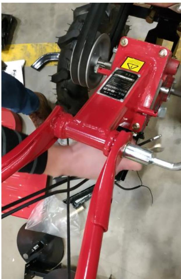
10. Установите рычаг переключения передач
