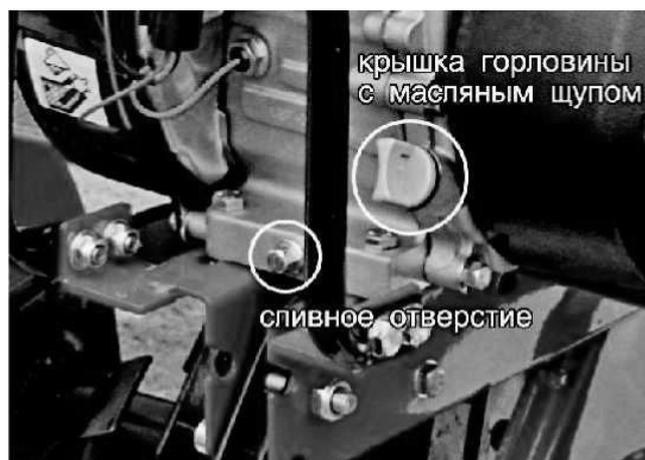
**Примечание:** возможен контроль уровня масла и при отсутствии масляного щупа. Уровень масла должен доходить до нижнего края маслоналивной горловины.
