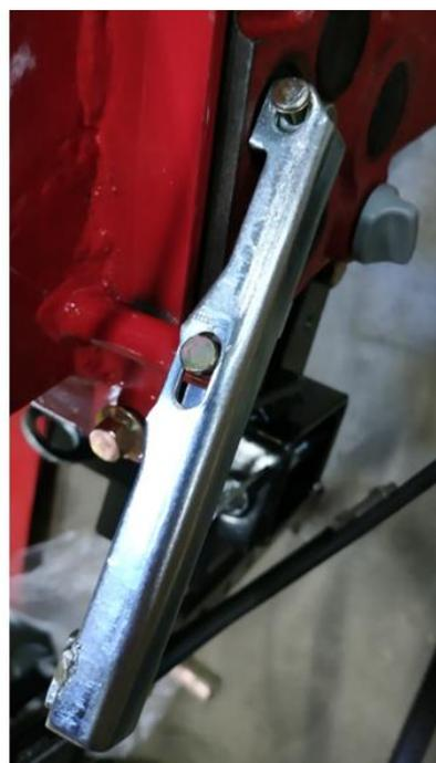
16. Подключите трос идущий от рукоятки сцепления и предварительно отрегулируйте натяжение троса. Окончательную регулировку произведите после полной сборки культиватора и заправки всех технических жидкостей.
