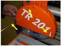
• Используя ключ 19 мм открутить шестигранную гайку затяжки фланцев.
