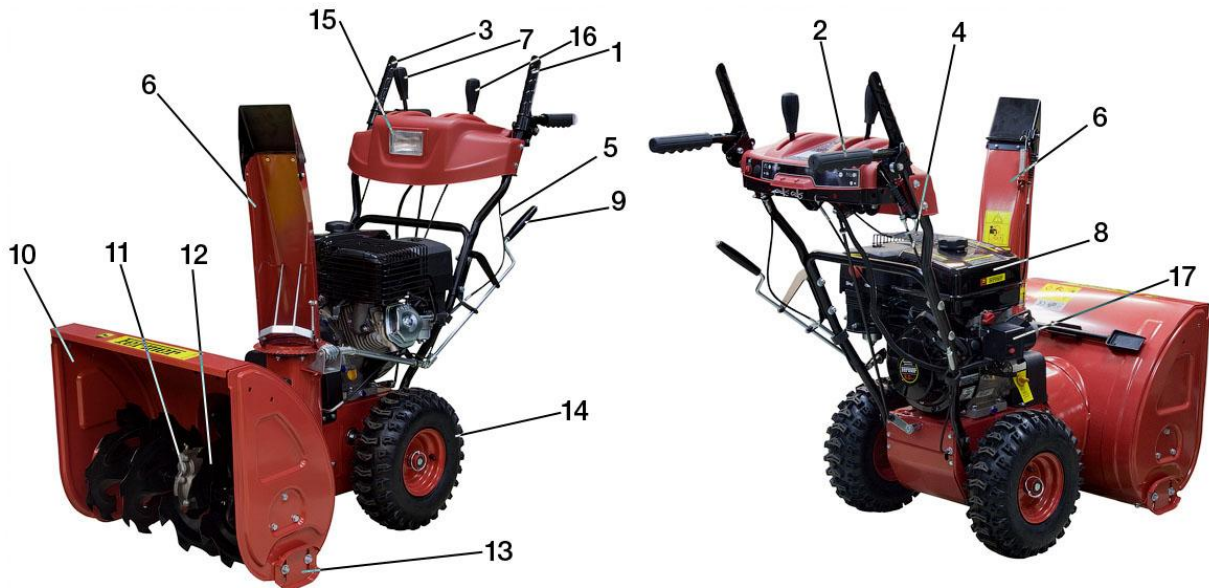
Рис. 1. 1. Рычаг привода колёс. 2. Рукоятка управления. 3. Рычаг привода шнека. 4. Трос привода колёс. 5. Трос привода шнека. 6. Жёлоб для выброса снега. 7. Рычаг переключения скоростей. 8. Топливный бак. 9. Рукоятка поворота желоба. 10. Снегозаборник. 11. Редуктор. 12. Шнек. 13. Ограничительный башмак. 14. Колесо. 15. Фара. 16. Рычаг установки дальности выброса снега. 17. Розетка.
