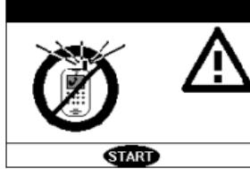
START      | Äußere Einflüsse wie Handy, Mikrowelle oder Mobilfunksendemasten stören die Messung.             | Störeinflüsse, wenn möglich, abschalten. Neue Messung durch Drücken der Taste „start“ 6 beginnen.             |
