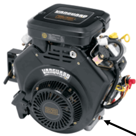
Рис. 4.6: Удаление винта для слива масла
