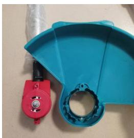
**1.2 С помощью винта зафиксируйте кожух:**
