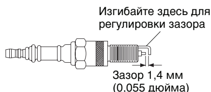
Рис. 12. Регулировка зазора свечи зажигания, нагреватель мощностью 10 кВт
