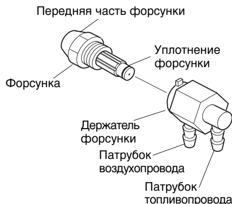
Рис. 22. Форсунка и держатель форсунки, нагреватель мощностью 10 кВт
