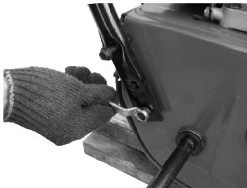
Шаг 3: Снимите колеса. Прикрепите рукоятку к корпусу машины, закрепите ее шурупами и снова прикрутите колеса
