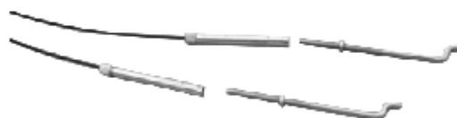
Step 7: 7-1) Снимите тяги с соединительных кабелей.
