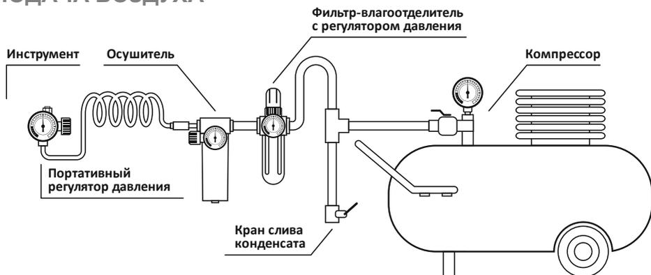
✓ Для обеспечения данного инструмента питанием рекомендуется подача чистого воздуха, осуществляемая под соответствующим данному инструменту давлением. Для большинства пневматических инструментов данного класса максимальное рекомендованное давление составляет 6,0 бара. Информация по рекомендованному давлению приведена в разделе «Технические характеристики».
