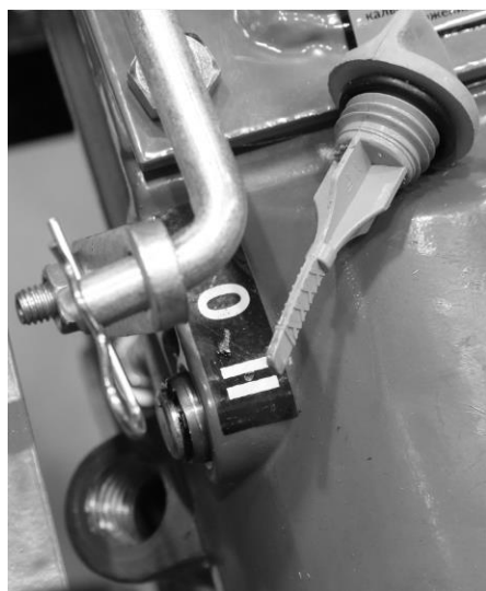
Рисунок 5 – Проверка уровня масла в корпусе редуктора
