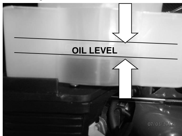
Рисунок 7 – Уровень масла в корпусе воздушного фильтра
