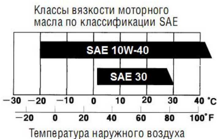
Рисунок 3 – Классы вязкости масла по классификации SAE
