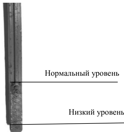
Рисунок 5 – Проверка уровня масла в корпусе редуктора
