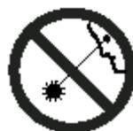
**Не допускается направлять лазерный луч на других лиц.** Узкий сфокусированный поток лазерного излучения представляет опасность и на большом расстоянии, поэтому необходимо исключить нахождение посторонних лиц на пути распространения луча.
