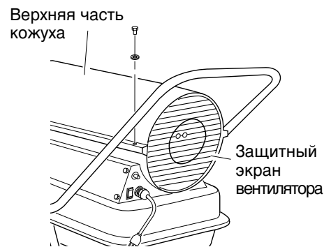
Рис. 8. Снятие верхней части кожуха, нагревателя мощностью 29 и 44 кВт
