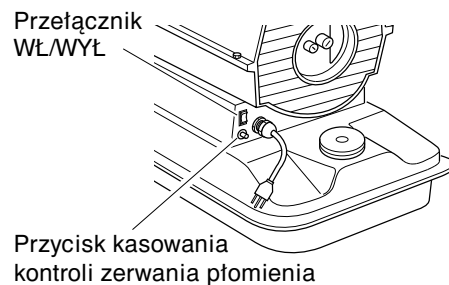
Rysunek 5 – Przycisk kasowania kontroli zerwania płomienia, modele 10kW, 20kW
