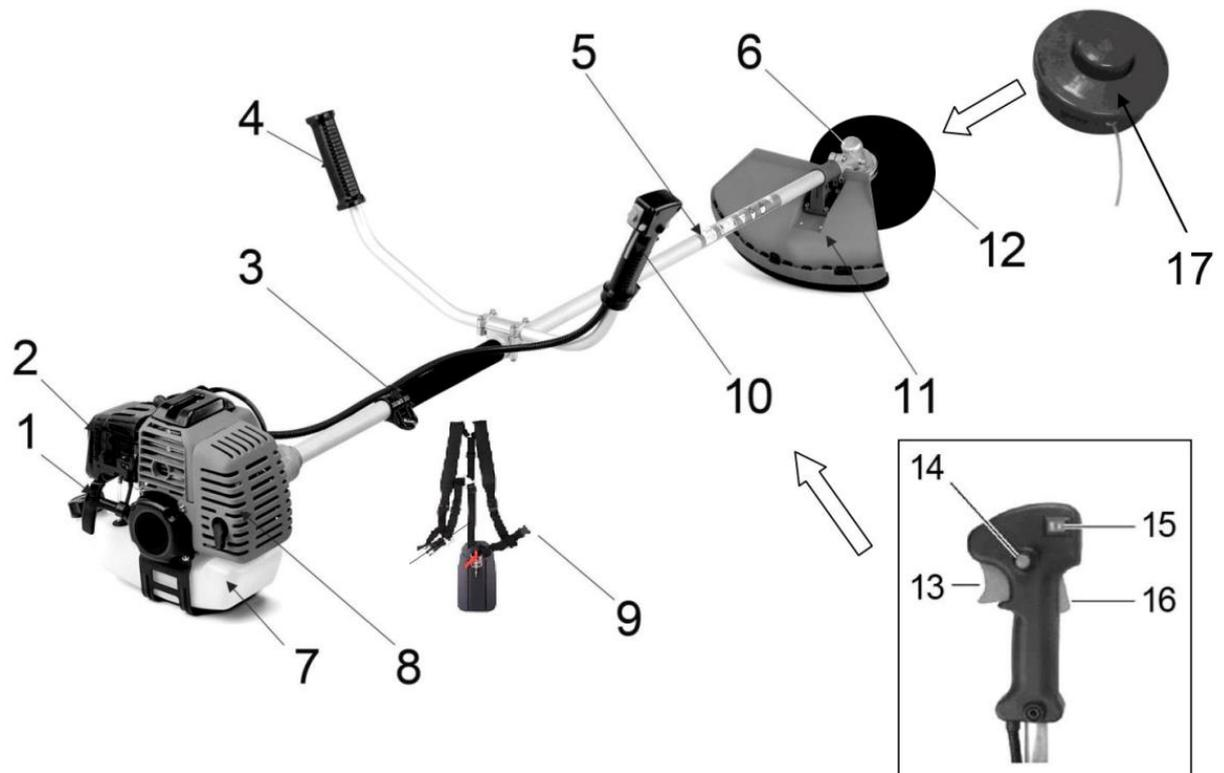
1.Рукоятка ручного запуска. 2.Рычаг управления воздушной заслонкой карбюратора. 3.Скоба крепления ремня. 4.Ручка. 5.Штанга алюминиевая. 6.Редуктор. 7.Топливный бак. 8.Глушитель. 9.Ремень плечевой. 10.Рукоятка управления. 11.Защитный кожух. 12.Нож. 13.Пусковая клавиша (рычаг управления дроссельной заслонкой). 14.Фиксатор пусковой клавиши. 15.Выключатель зажигания. 16.Блокиратор пуска 17.Катушка с леской.
