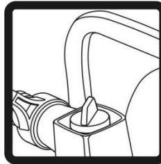
4. Закрутите заливную пробку центробежного насоса.
