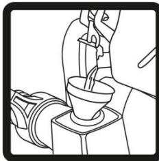
3. Открутите заливную пробку и заполните центробежный насос водой до края.
