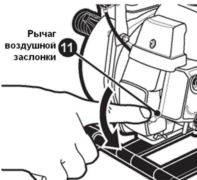
После того, как двигатель запустится, медленно откройте воздушную заслонку и оставьте ее в полностью открытом положении. Не переводите рычаг воздушной заслонки 11 в полностью открытое положение сразу же после запуска двигателя, если двигатель является холодным, или он запускается при низкой температуре окружающего воздуха, так как при этом двигатель может остановиться.
