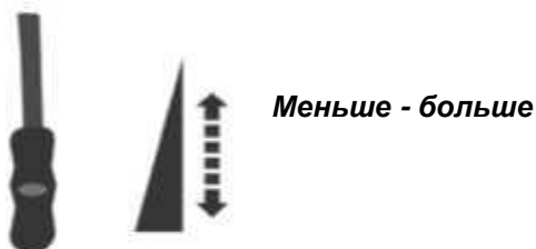
Рисунок 3.8. Рычаг регулировки подачи топлива («ручной газ»)
