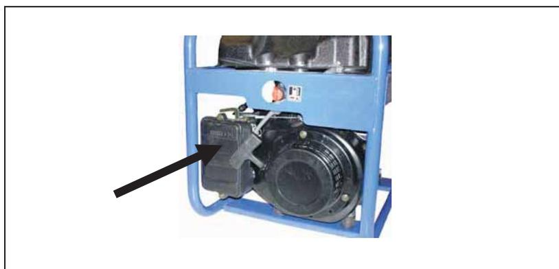
1. Снимите крышку с корпуса воздушного фильтра
