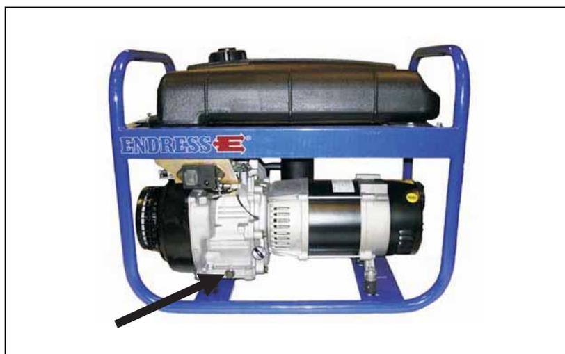
Откручивание пробки картера
