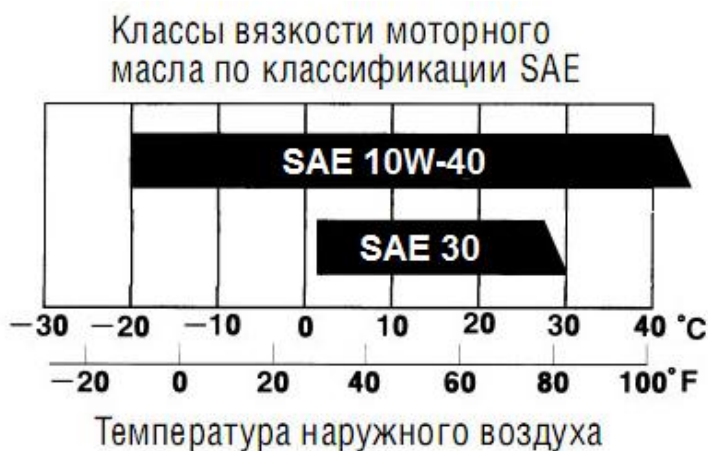
Рисунок 4 – Классы вязкости масла по классификации SAE
