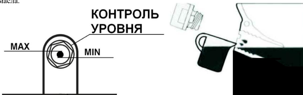
Рисунок 6 – Проверка уровня масла в корпусе редуктора
