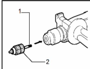
Чтобы можно было работать с инструментами без хвостовика типа „SDS-plus“ (напр., для работы сверлами с цилиндрическим хвостовиком), необходимо установить сверлильный БЗП патрон, снабженный хвостовиком типа „SDS-plus“ или при использовании специального адаптера.
