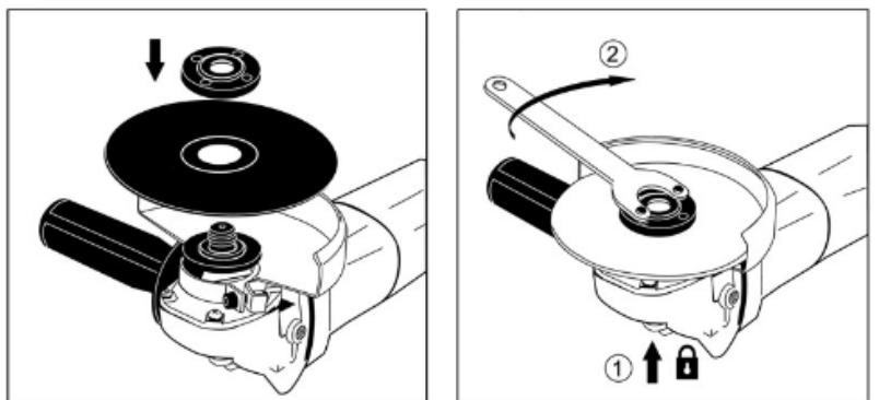
**Внимание!** Запрещается пользоваться кнопкой-фиксатором (1) для остановки вращающегося шпинделя. Это может привести к повреждению устройства!
