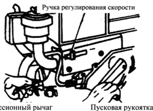
Рис. 11 Запуск двигателя при помощи ручной пусковой рукоятки
