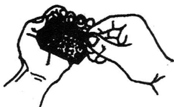
Рис. 20 Удалите нагар с игольчатого клапана
