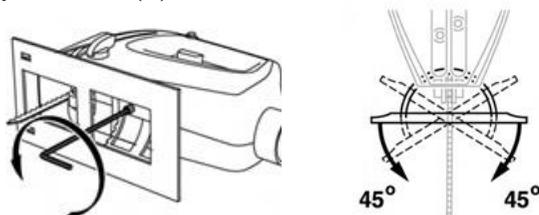
**Помните!** Пиление под углом производится только в прямом направлении. Изменение направления пиления может привести к поломке пильного полотна и, как следствие, к травмам.
