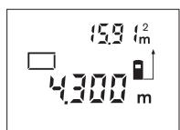
По окончании второго измерения площиадь автоматически рассчитывается и высвечивается на дисплее. Последнее единичное измеренное значение высвечивается на дисплее внизу, а конечный результат – вверху.
