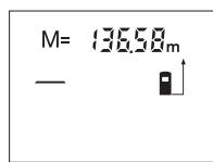
Stlačte tlačidlo na vyvolanie pamäte **4**, aby sa zobrazila hodnota, ktorá je uložená v pamäti. Na displeji sa zobrazí symbol pamäti „**M=**“. Ked' sa na displeji zobrazí obsah pamäte „**M=**“, môžete ho stlačením pripočítavacieho tlačidla pamäte **2** zdvojnásobiť, resp. stlačením odpočítavacieho tlačidla pamäte **8** zredukovať na nulu (vynulovať).
