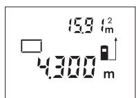
Pärast teise mõõtmise teostamist arvutatakse pindala automaatselt välja ja kuvatakse ekraanile. Viimase üksiku mõõtmise väärust näidatakse ekraani alumises osas, lõppulemust ülemises osas.
