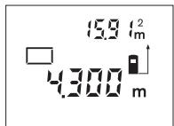
A második mérés befejezése után a készülék automatikusan kiszámítja és kijelzi a felületet. Az utolsó egyedi mérés eredménye a kijelző alsó részén, a végeredmény pedig fent látható.
