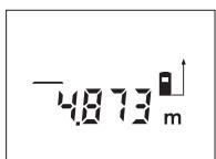
Jeden raz stlačte tlačidlo meranie **12** na zameranie laserového lúča a potom znova na vykonanie merania.
