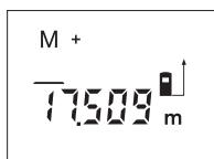
Slačte tlačítko přičítání k paměti **2**, aby se aktuální naměřená hodnota – podle aktuální měřící funkce hodnota délky, plochy nebo objemu – uložila do paměti. Jakmile se hodnota uložila, objeví se na displeji „**M**“, znak „+“ za ním krátce zabliká.
