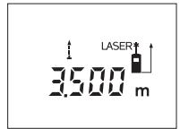
Чтобы начать процесс измерения, нажмите кнопку измерения **12**. Передвигайте измерительный инструмент, пока внизу на дисплее не отобразится желаемое расстояние.
