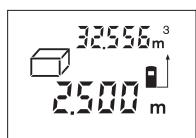
Nakon isključivanja trećeg mjerena, automatski će se izračunati i pokazati volumen. Zadnja pojedinačna izmjerena vrijednost nalazi se dolje na displeju, a krajnji rezultat gore.
