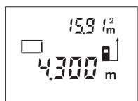
След второто измерване площта се изчислява и изобразява автоматично. В долната част на дисплея се изобразява последно измерената стойност, в горната – резултатът от измерването на площ.
