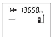
Pritisnite tipku za pozivanje memorije **4**, za pokazivanje vrijednosti koja se nalazi u memoriji. Na displeju se pojavljuje „**M=**“. Ako se na displeju pokaže sadržaj memorije „**M=**“, tada ga pritiskom na tipku memorije za zbrajanje **2** možete podvostručiti, odnosno pritiskom na tipku memorije za oduzimanje **8** svesti na nulu.
