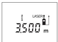
A mérési folyamat kiváltásához nyomja meg a **12** mérési billentyűt. Mozgassa el addig a mérőműszert, amíg a kijelző alsó részén meg nem jelenik a kívánt távol-ságérték.
