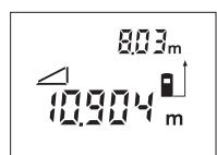
Після закінчення другого вимірювання відстань **B** розраховується автоматично. Останнє одниничне вимірюване значення відображається внизу на дисплеї, кінцевий результат **B** відображається угорі.
