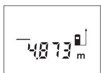
Нажмите кнопку измерения **12** один раз для наведения и еще один раз для выполнения измерения.
