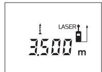
Щоб розпочати вимірювання, натисніть на кнопку вимірювання **12**. Пересувайте вимірювальний пристрій до тих пір, поки внизу на дисплеї не висвітиться необхідна відстань.
