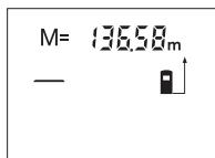
Slačte tlačítko vyvolání paměti **4**, aby se v paměti uložená hodnota zobrazila. Na displeji se objeví „**M=**“. Pokud je na displeji zobrazen obsah paměti „**M=**“, pak jej můžete stlačením tlačítka přičítání k paměti **2** zdvojnásobit ev. stlačením tlačítka odčítání od paměti **8** stanovit na nulu.
