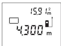
Після закінчення другого вимірювання прилад автоматично розраховує площе і показує результат. Останнє однічне виміряне значення показується внизу на дисплеї, кінцевий результат знаходитьться угорі.
