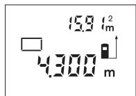
Nakon završenog drugog mjerena, automatski će se izračunati i pokazati površina. Zadnja pojedinačna izmjerena vrijednost nalazi se dolje na displeju, a krajnji rezultat gore.
