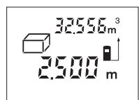
Після закінчення третього вимірювання пристрій автоматично розраховує об'єм і показує результат. Останнє одниничне вимірюване значення показується внизу на дисплеї, кінцевий результат знаходиться угорі.
