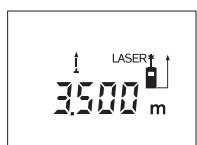
Stlačte tlačidlo Meranie **12**, aby ste spustili meranie. Merací prístroj pohybujte dovtedy, kým sa dole na displeji zobrazí požadovaná hodnota vzdialenosť. Stlačením tlačidla meranie **12** sa trvalé meranie preruší. Aktuálna nameraná hodnota sa ukáže na displeji. Nové stlačenie tlačidla meranie **12** spustí trvalé meranie znova.
