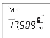
Натисніть на кнопку додавання до пам'яті **2**, щоб зберегти актуальне вимірюване значення – в залежності від актуальної функції вимірювання це може бути довжина, площа або об'єм. Тільки-но значення буде записане в пам'ять, на дисплей з'являється «**M**», за ним коротко мигає «**+**».
