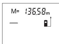
Lai uz displeja nolasītu mērinstrumenta atmiņā ierakstito vērtību, nos piediet atmiņas saturā nolasīšanas taustiņu **4**. Uz displeja parādās atmiņas saturā nolasīšanas indikators „**M=**“. Ja uz displeja ir redzams atmiņas saturā nolasīšanas indikators „**M=**“, tad, nos piežot pieskaitīšanas taustiņu **2**, atmiņas satura divkāršojas, bet, nos piežot atņemšanas taustiņu **8**, atmiņas satura kļūst vienāds ar nulli.
