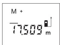
Lai ierakstītu mērinstrumenta atmiņā pašreizējo mērijuma rezultātu, kas iegūts garuma, laukuma vai tilpuma mērišanas režīmā, nospiediet pieskaitīšanas taustiņu **2**. Ierakstot mērijuma rezultātu atmiņā, uz displeja parādās atmiņas saturā indikators „**M**“ un īslaicīgi klūst redzams apzīmējums „**+**“.
