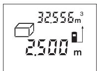
След приключване на третото измерване обемът се изчислява и изобразява автоматично. В долната част на дисплея се изобразява последно измерената стойност, в горната – резултатът от измерването на обем.
