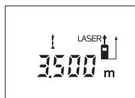
Pritisnite taster merenje **12** za pokretanje merenja. Pokrećite merni alat toliko dugo, sve dok se dole na displeju ne pokaže željena vrednost rastojanja.
