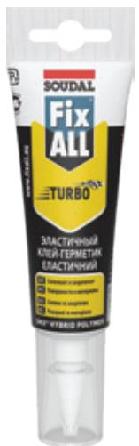
Очень быстрый клей-герметик на основе гибридных полимеров SMX. Фиксация в течение 20 минут. Возможна регулировка в течение 5 минут. Окончательная прочность достигается после 3 часов. Характеризуется отличной адгезией ко всем строительным материалам. Клеит также влажные материалы.
