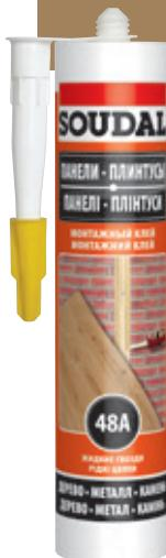
Водостойкий клей на основе синтетического каучука. Содержит растворители. Обладает высокой силой соединения и отличной адгезией к различного вида строительным материалам, за исключением полипропилена (ПП) и полиэтилена (ПЭ). Заменяет гвозди и шурпулы. Не использовать с пенопластом.
