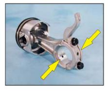
Масло распределяется на критическом месте с двумя отверстями смазывания на большую поверхность.
