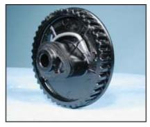
Пластмассовый кулачок и шестерня на двигателе Honda GC приводят в действие металлические коромыслы.
