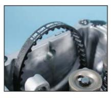
Резиновый приводной ремень управляет пластмассовый кулачок. Ремень работает в горячей окружающей среде картера.
