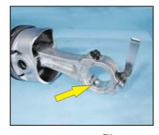
У моторов B&S Intek $^{\text{TM}}$  только единственное отверстие смазывания.
