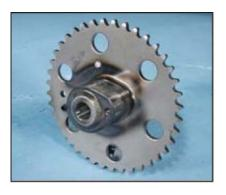
Укрепленный стальной кулачок и шестерня управляют критические коромыслы и впускный и выпускный клапаны.
