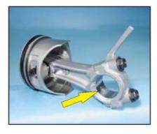
У моторов Honda GC используют только единственное отверстие смазывания.
