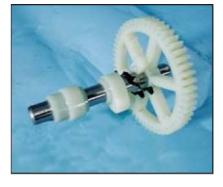
Двигатель Intek<sup>TM</sup> использует пластмассовый кулачок и шестерня чтобы управлять металлические рычаги управления клапанов.
