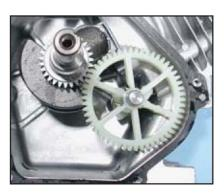
Кулачки Intek<sup>TM</sup> управляется пластмассовым шестернием приведенного от металлического механизма коленчатого вала.
