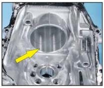
В двигателе HONDA GC не используются гильзу цилиндра. Они полагаются на более мягкую алюминиевую цилиндрическую скуку сплава.
