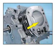
Стандартный двигатель Intek не использует гильзу цилиндра. Некоторые выше оцененные версии действительно используют гильзы.
