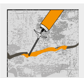
Заполнение трещин и пустот;
