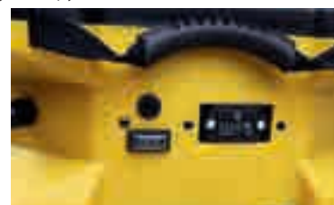
Панель управления CDX 20, таймер наработки часов
