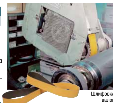
Шлифовка и восстановление заводской риски
