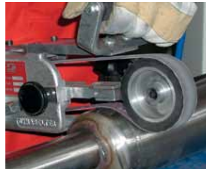
Шлифовка нержавеющей стали
