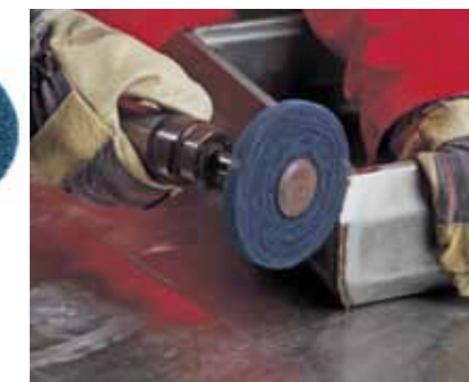
Зачистка стыкового сварного шва
