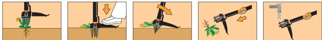
Greifarme des Unkrautstechers um das Unkraut setzen. Pedal mit dem Fuß herunterdrücken. Stiel zum Pedal ziehen. Unkraut aus den Greifarmen durch Ziehen des orangefarbenen Griffs entfernen. Unter fließendem Wasser reinigen.
