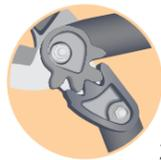
Fiskars Getriebemechanismen (PowerGear™ und PowerGear™ II) optimieren die Kraftverteilung, damit die Schneidkraft dann verstärkt wird, wenn sie am meisten benötigt wird:
