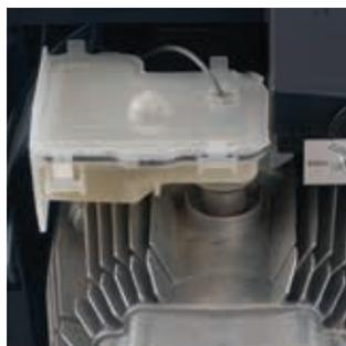
Индикатор уровня масла и масляный резервуар с встроенной системой аварийного отключения. Обслуживание максимально упрощено. Аппарат защищен от функционирования при отсутствии масла, а это обеспечивает более долгий срок эксплуатации.
