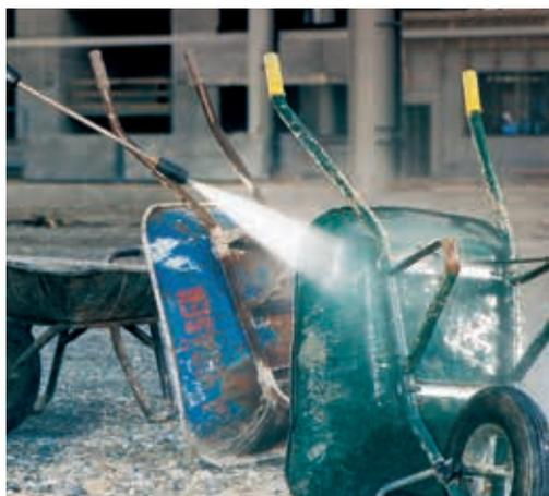
◀ Линейка POSEIDON PE и DE оптимально подходит для применения в условиях отсутствия энергоснабжения, либо при его недостаточной для тяжелых клининговых задач мощности. Благодаря системе всасывания, можно заливать воду из бака, пруда, озера или другого природного источника. Используются в мелких розничных магазинах, строительных организациях и с/х.
