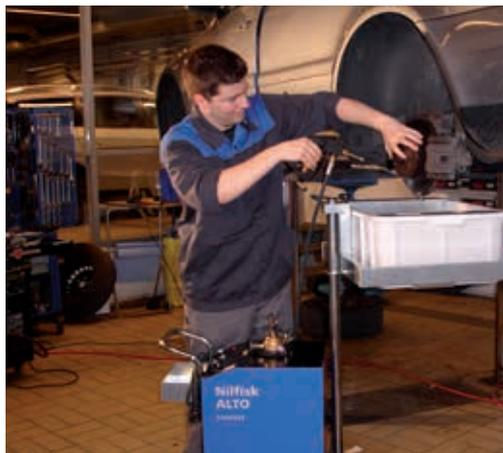
◀ Быстрая и легкая очистка тормозной и трансмиссионной системы, а также других мелких частей. Мобильные аппараты для промывки тормозной системы и запасных частей исключают риск вдыхания опасной пыли.
