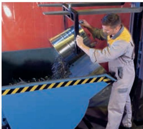
▶ Контейнер большого объема из нержавеющей стали, с возможностью опустошения до минимума, позволяет продлить время работы пылесоса. Практичное положение контейнера для удобного опустошения способствует быстрой и эффективной работе.
