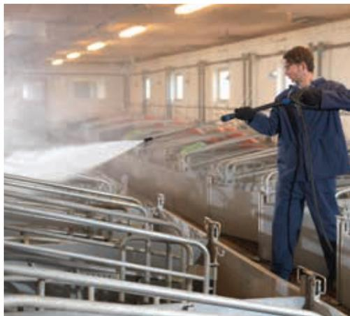
DUO BOOSTER 7 оборудован системой управления, которая автоматически отслеживает уменьшение или повышение необходимого уровня воды, когда пользователь начинает или останавливает работу аппарата (активируя пусковой крючок пистолета). При этом помпы аппарата соответственно запускаются, либо отключаются.
