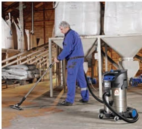
Встроенный сенсор воздушного потока и акустический предупреждающий сигнал контролируют скорость воздуха в вакуумном шланге, не позволяя ей опускаться ниже 20 м/с. Использование вакуумных шлангов различного диаметра легко регулируется на главной панели управления.
