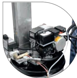
SOLAR BOOSTER G – аппарат, оборудованный одноступенчатой горелкой Ventone. Нагревание происходит после помпы, под высоким давлением.
