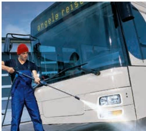
◀ NEPTUNE 7 FA оснащен помпой премиум класса С3 и идеально подходит для интенсивного использования. Версия FA позволяет перейти на новый уровень надежности и комфорта благодаря системе разгрузочного клапана, в которой потоки воды посредством сенсора передают сигналы старт- стоп к мотору.
