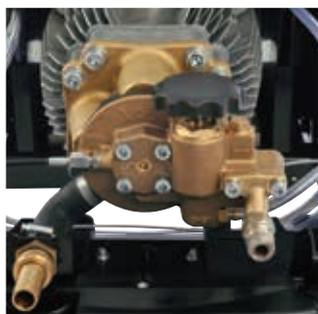
Высокоэффективные впускные и выпускные клапана выполнены из нержавеющей стали. Система отключения, срабатывающая при прекращении подачи воды, обеспечивает оптимальное удобство при эксплуатации. Сюда же можно включить датчик потока воды и клапан подачи моющего вещества.
