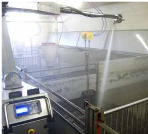
Удобный в программировании MULTICLEANER 7-53 – автоматический роботизированный АВД. Способен выполнять 80% клининговых операций на фермах. Датчики направления движения и доп. оборудование для использования химии и дезинфицирующих средств, а также распознавание предметов в убираемой зоне. Легкая транспортировка.
