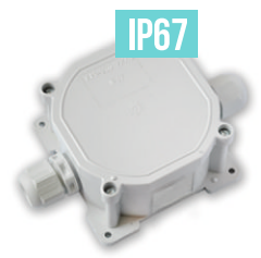
KM-238 (2 ввода) Коробка с клемными колодками для разводки проводов, IP67 и УХЛ2 Размер коробки: D 75,7 h 44,5 мм Габаритный размер: 130x78,5x44,5 мм
