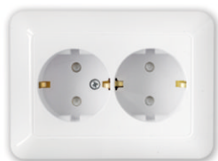
PC16-384 Розетка двухместная с э/к со шторками. Установка в одноместную коробку, 110x80x39,1 мм
