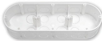
К-214* Коробка для трехместной рамочно-узловой системы сборки при скрытой проводке Размер коробки: 212x70x42 мм
