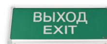
ДБ003-1,3-001 УХЛ4 Светильник светодиодный настенный для аварийного освещения общественных зданий. Время работы светильника в аварийном режиме - 90 мин
