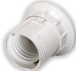
E27PK-003 Патрон электрический пластмассовый с абажурным кольцом Ток - 4А, 60Вт D55,5x55,5 мм
