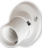
E14P-005 Патрон с резьбой E14 Ток - 2А, 40Вт D28x52 мм
